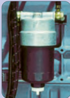
Крупногабаритный дизельный фильтр с водоотделителем и сливной пробкой.
